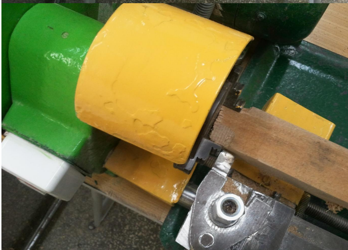
Prawidłowo zamocowany element i nóż skrawający, zamknięta osłona uchwytu samocentrującego
